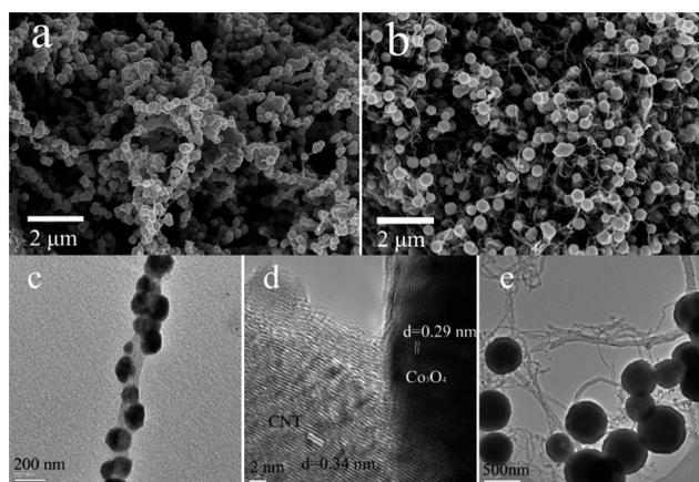
**Fig. 3** SEM images of (a)  $Co_3O_4$ -f-CNT and (b)  $Co_3O_4$ -p-CNT composites. (c) TEM image of a  $Co_3O_4$ -f-CNT composite. (d) HRTEM image of the cross-section of the  $Co_3O_4$ -f-CNT composite. (e) TEM image of a  $Co_3O_4$ -p-CNT composite.
